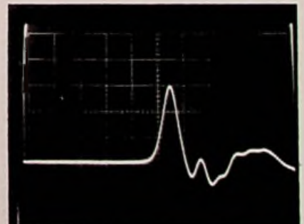
Afb. 1 Stroompuls door LED in zender van fig. 2. Hor. 10 ns/div, vert. 100 mA/div.
